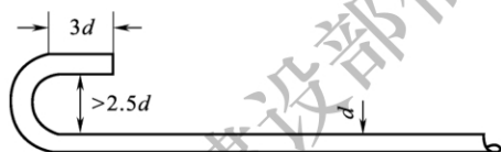
图 5.2.2-1 钢筋端头弯钩图
